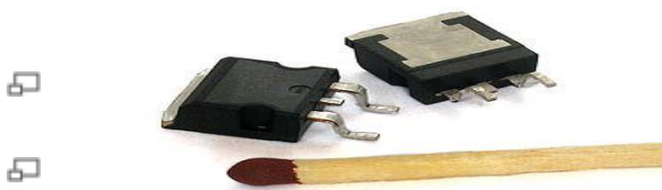
Слика 2. Узорци MOSFET транзистора
